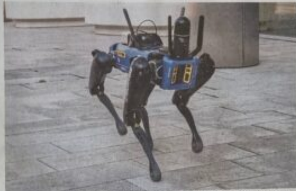
Roboterhund „Spot“ soll mit seinem aufmontierten Laserscanner die Umgebung erkunden
